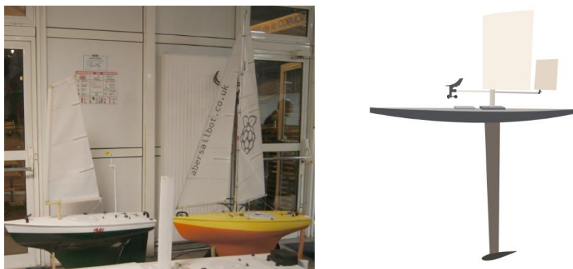
(a) 配备重型船体的无人帆船 [24] (b) 配备低矮帆及超长龙骨的无人帆船 [73]
