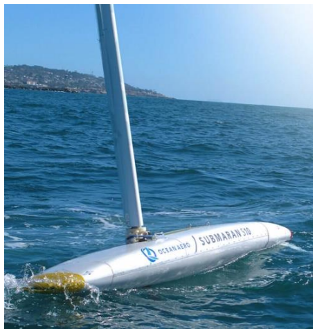
图 1-6 可以将帆折叠后下潜的 Submaran S10 无人帆船 [41]
